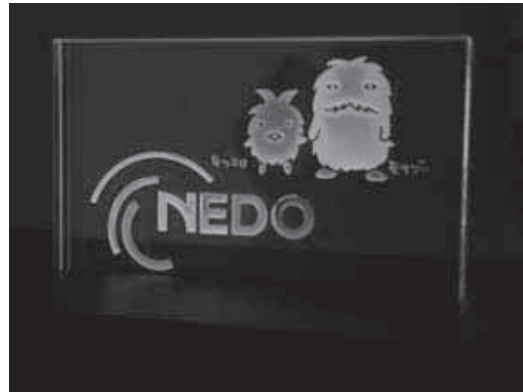
図2. 図1のCdTe量子ドットを用いて作製したガラス蛍光体。ガラス中で始めて、発光効率をほぼ保ちつつ量子ドットを分散することができた。このときの量子ドットの分散濃度は、10 -5 モル/リットルの程度である。
