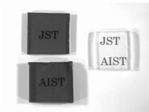
図2 着色廃ガラス(左)とそれを処理して得られた多孔質ガラス(右)
