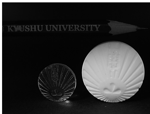
図3 右) メソポーラスシリカガラス, 左) 焼結シリカガラス
