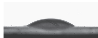
図 5 pH 応答ガラスの水に対する接触角
