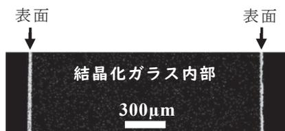
図2 350℃のNaNO<sub>3</sub>およびNa<sub>2</sub>SO<sub>4</sub>混合塩中で1hイオン交換したマイカ結晶化ガラス断面のNaマッピング
