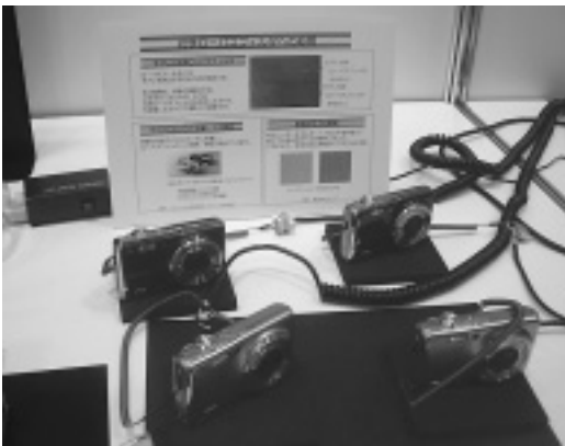
写真2 三次元一括加工した光学ローパスフィルタ装着カメラ
